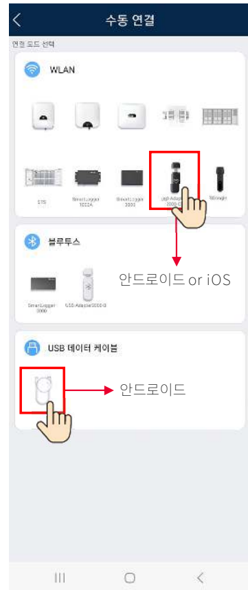
② 안드로이드는 USB 케이블 혹은 Wi-Fi 어댑터 사용, iOS는 Wi-Fi 어댑터 사용
